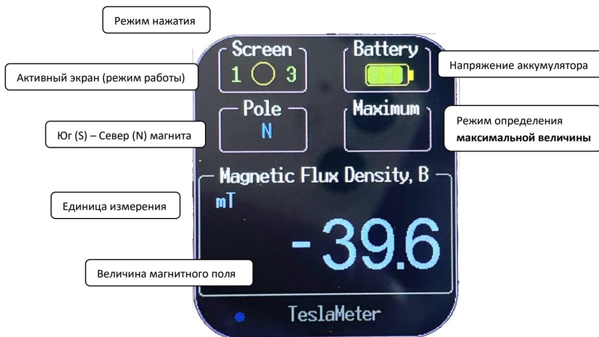
Для большинства измерений магнитного поля основного режима работы тесламетра будет достаточно. Однако если требуется дополнительная функциональность, можно воспользоваться единственным устройством ввода – боковой кнопкой **2** (*Tact Button*).
