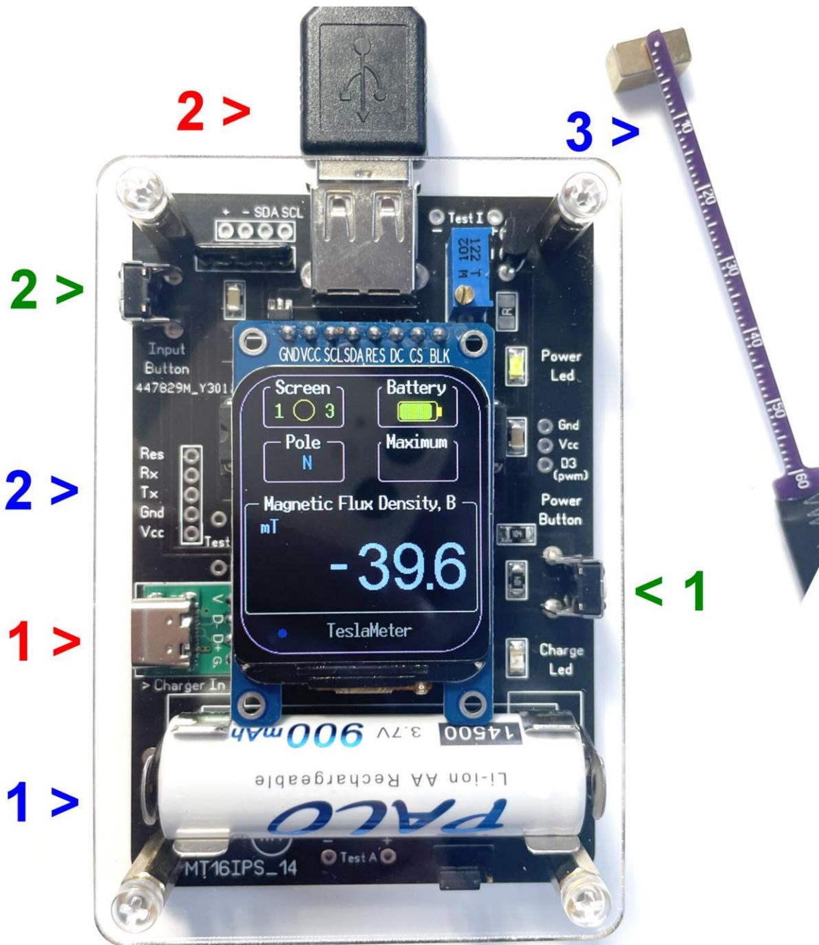
1. Аккумулятор *Li-Ion 3.7 V 800 (900) mAh AA*
